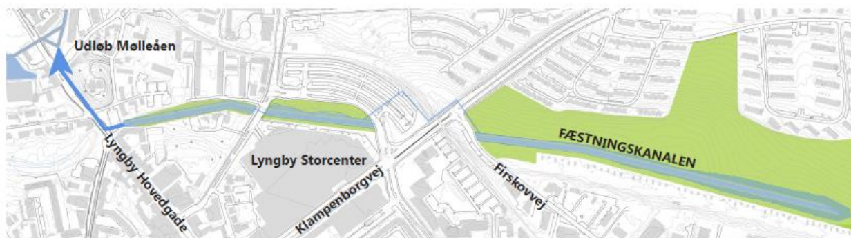
Regnvandet fra byen ledes via den reetablerede Fæstningskanal fra Ermelundskilen i øst til Lyngby Hovedgade i vest, før det i sidste ende udledes i Mølleåen.
